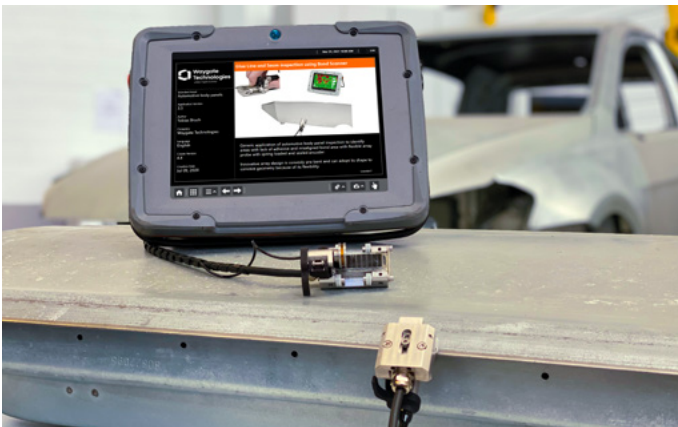
Krautkrämer Bond Scanner ermöglicht die schnellsten und einfachsten Tests von Klebeverbindungen
