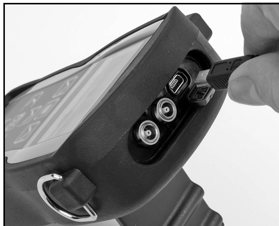
Figure 21 : Emplacement du port COM Mini USB
