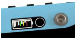
图 2：电池状态指示灯
