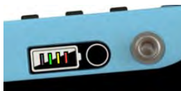
Slika 2: Indikator statusa baterije
