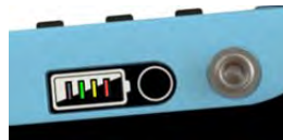
Figure 2 : Témoin d'état de la batterie
