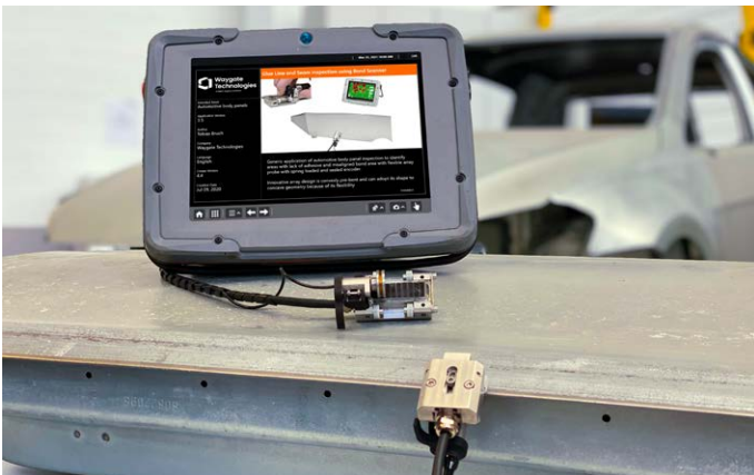
O Krautkrämer Bond Scanner permite o teste mais rápido e fácil de peças adesivadas.
